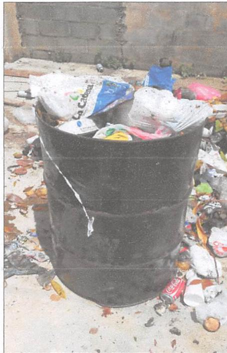
**Figura 4.** Residuos sólidos en tanque para calcular densidad.
